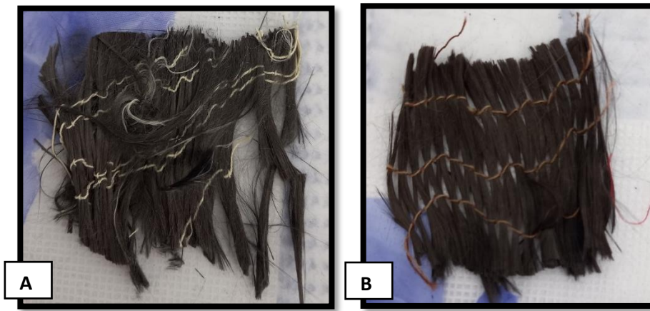
Figura 3.2 Electrodo de fibra de carbón: (A) Ánodo y (B) Cátodo
