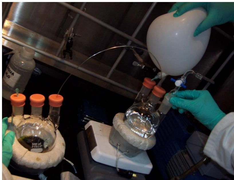
Fig. 2.6 Adición del cloroformo con cánula al \text{FeCl}_3 .
