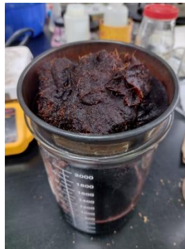
Fig. 2.17 Filtrado con malla 200 \mu\text{m}
