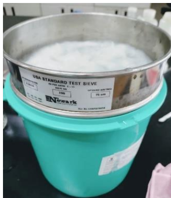
Fig. 2.21 Filtrado en malla 200 μm Fig. 2.22 Celulosa, húmeda (a) y seca (b)
