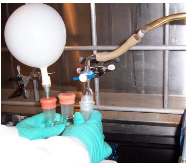
Fig. 2.5 Purga con nitrógeno
