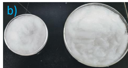
Fig. 2.21 Filtrado en malla 200 μm Fig. 2.22 Celulosa, húmeda (a) y seca (b)
