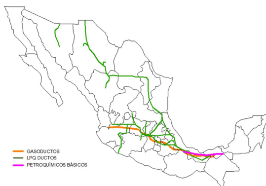
Figura 1. Ramaleo de ductos de PEMEX en la República Mexicana
