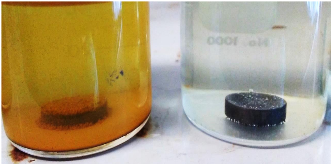
Figura 4. 65 Efecto protector del inhibidor LE-M. De lado izquierdo se presenta una muestra de acero al carbono 1018 en H_2SO_4 0.5 M en ausencia de inhibidor y de lado derecho se tiene la muestra con el ácido en presencia de 5 ml de inhibidor. El tiempo de inmersión fue de 15 días.
