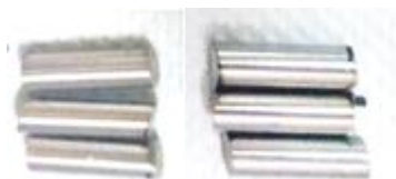
Figura 3. 4 Muestras metálicas utilizadas en la prueba de pérdida de peso.
