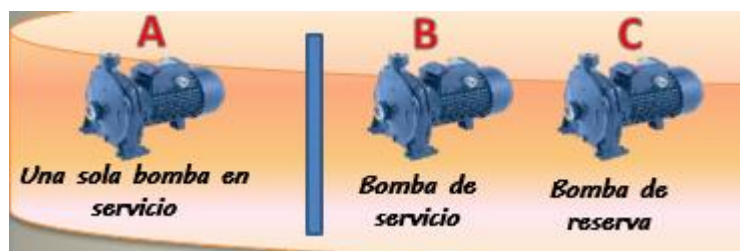
Figura 8: Disposición de Bombas, Principal y con redundancia
