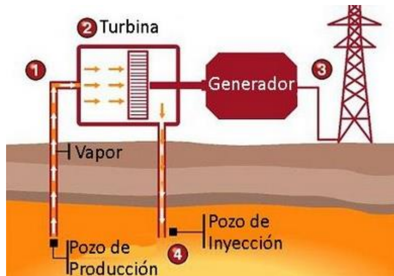
Fig. 15. Esquemas de generación geotermoeléctrica ( http://slideplayer.es/slide/161096/2/images/35/Energia+geotermica.jpg ).
