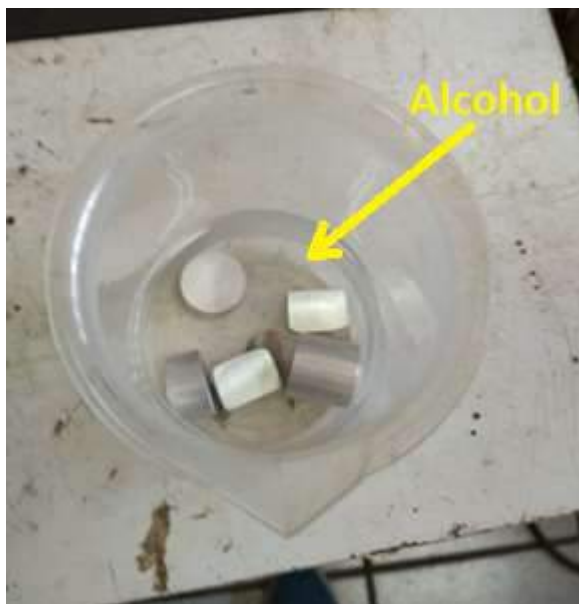
Figura 3.21 Limpieza de carga de fundición
