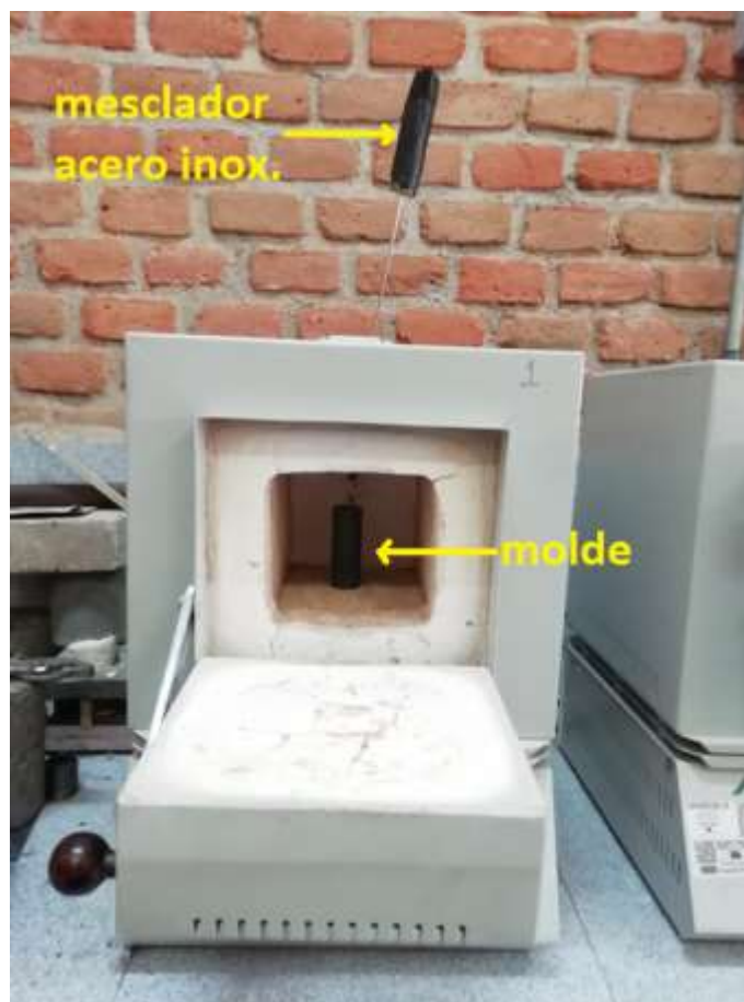
Figura 3.30 Mezclado de la aleación durante la adición de boro
