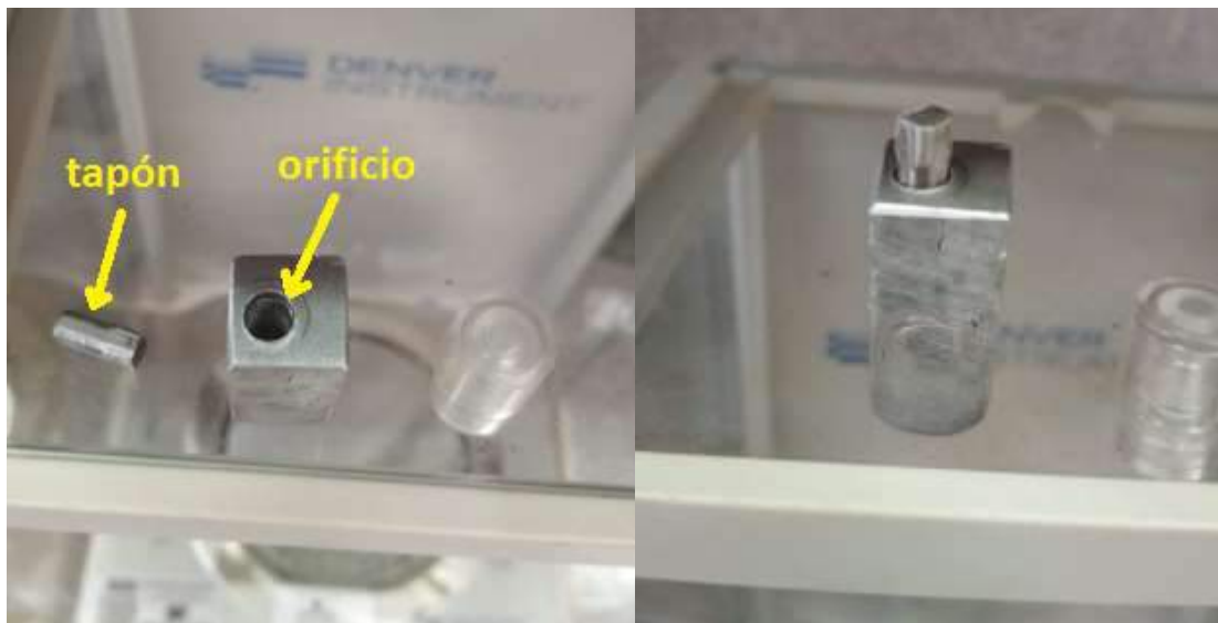
Figura 3.25 Orificio con tapón para adición de boro
