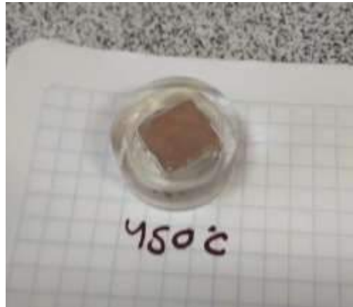
Figura 3.41 Molde de acrílico con resina epóxica
