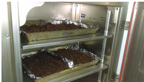
Figura. 2. Formulaciones (pellets) de las tres dietas con diferentes contenidos porcentuales del hongo Pleurotus djamor var. roseus (15, 20 y 25%), en proceso de secado en el horno a 60°C.
