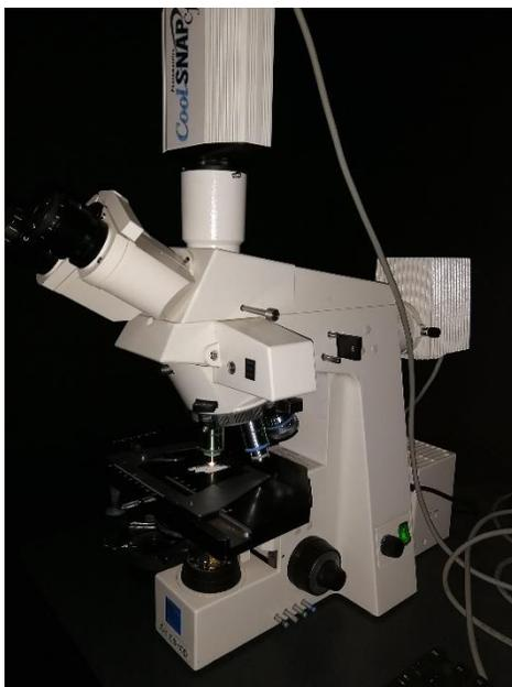
Figura 17.- Microscopio de epifluorescencia
