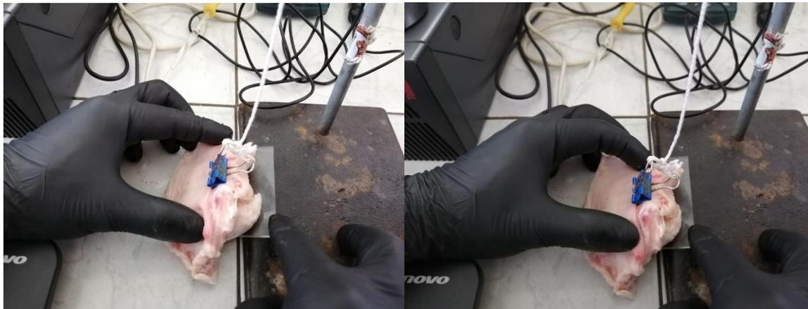
Figura 36.- Montaje para la medición de mucoadhesión
