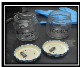
Figura. 3.1.3. Probetas después de test de inmersión.
