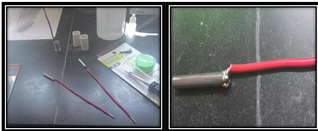
Figura 3.2. Soldadura de alambre de cobre y acero al carbón 1018.
