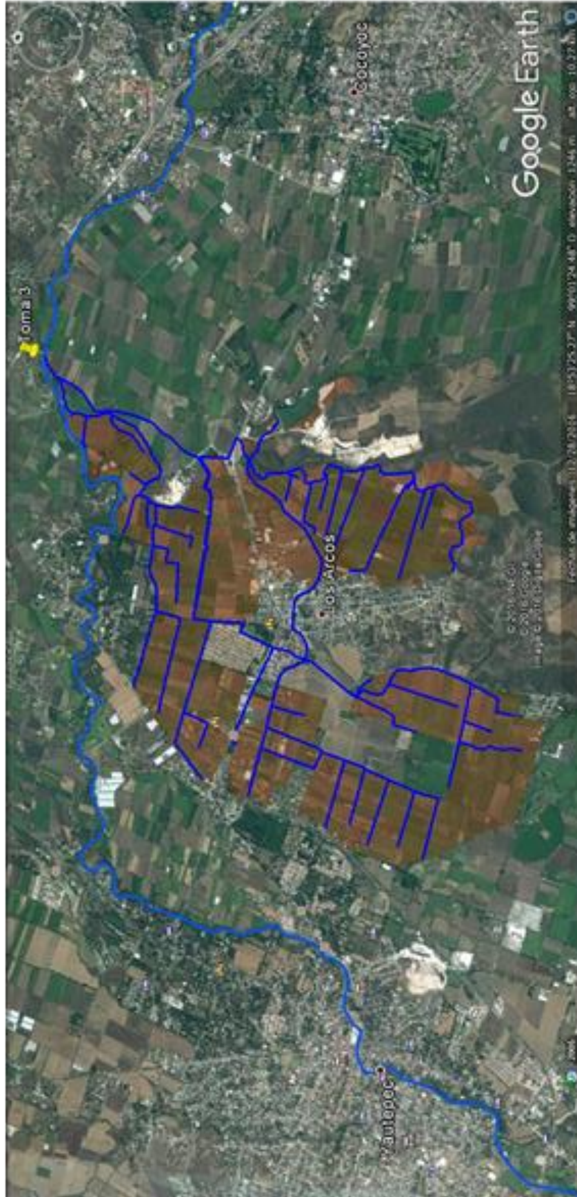
Figura 6. Área de riego y canales principales de la Toma 3
