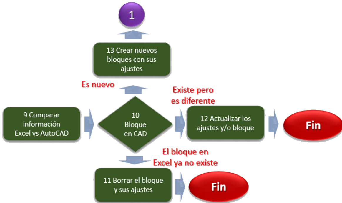
Figura 5.19 si la coordinación existente, decisión si la protección ya no existe o tiene ajustes diferentes o es nuevo.
