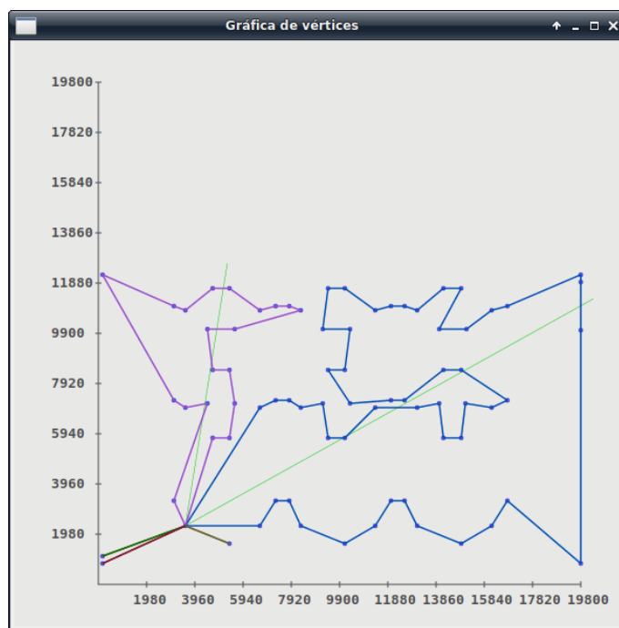
Figura A.1: Instancia pr76, 5 recorridos, c(T) = 133232 y tiempo de ejecución 2.91 seg.
