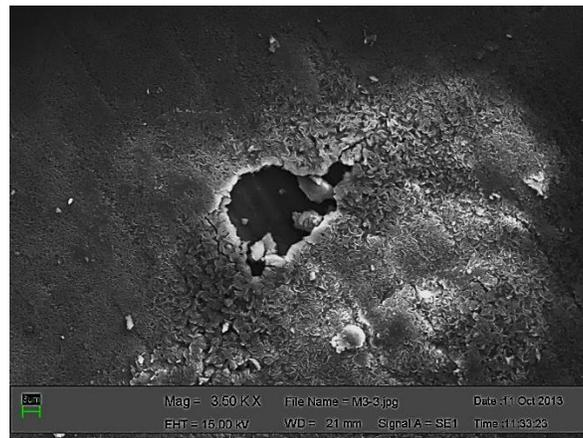
Figura 17. Picaduras en el revestimiento compuesto y posible señal de capacidades de reparación automática
