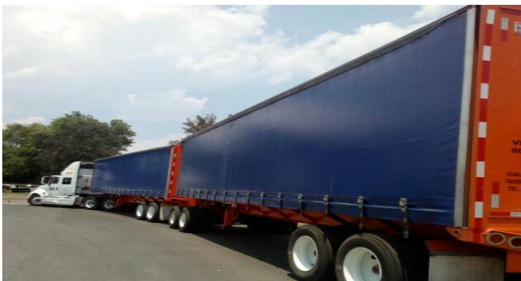
Fotografía 1. Autor: AR. Tracto-camión con dos remolques o full.
