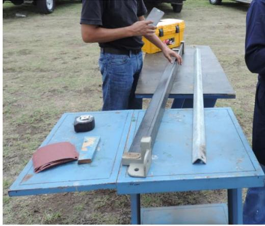
*Figura 5.8–1. Comparación de elementos redundantes de material compuesto de RVFC y acero.*
