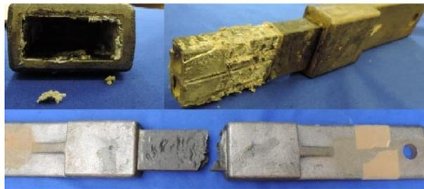
Figura 4.5.2–2. Conector de fundición de hierro nodular y perfil rectangular de PRFV al final de la evaluación.
