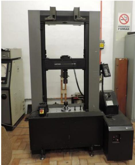
*Figura 4.2–1. Equipo universal para pruebas mecánicas.*
