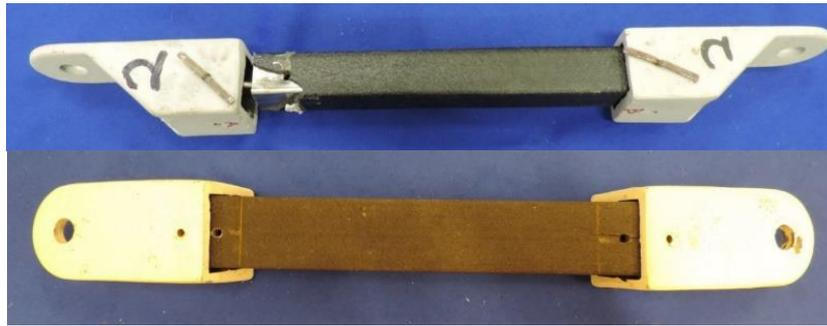
*Figura 4.6.11–2. Fractura del material de PRFV sujeta con tornillos.*
