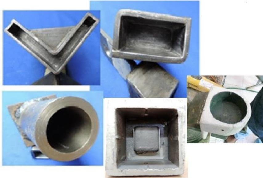
Figura 5.4.2–1. Preparación de los conectores de hierro nodular.
