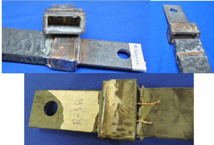
Figura 4.4.2–2. Conector de acero y perfil rectangular de PRFV al final de la evaluación.
