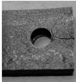
Figura 3.6–1. Fractura del material compuesto.
