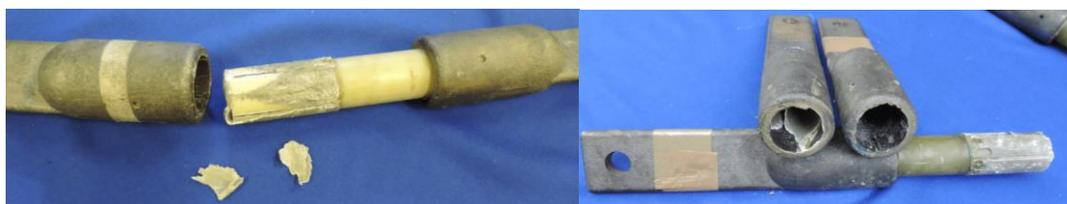
Figura 4.5.1–2. Conector de fundición de hierro nodular y perfil circular de REFV al final de la evaluación.
