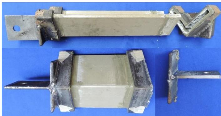
*Figura 4.5.3–2. Conector de fundición de hierro nodular y Perfil rectangular de RVEFV al final de la evaluación.*
