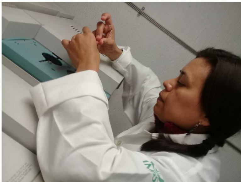
Figura 9. Inyección split en el cromatógrafo de gases acoplado a masas (Foto: Yolanda García).
