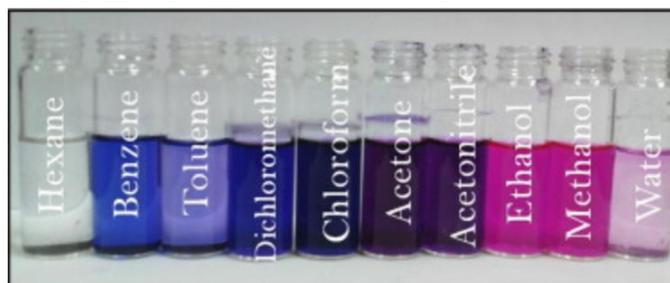
Figura 3. Fotografía del compuesto 7 mostrando cambios de color en diferentes disolventes.
