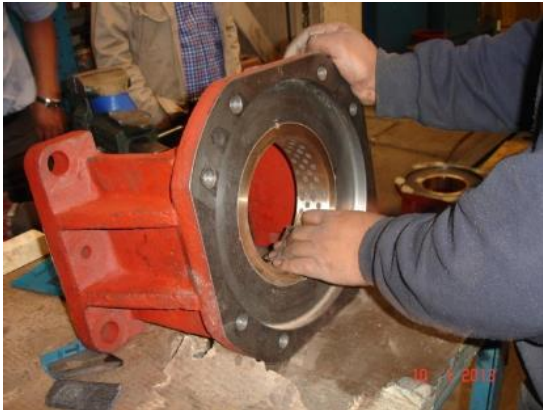
Figuras 5.2. y 5.3. Preparación de cojinetes de álabes.
