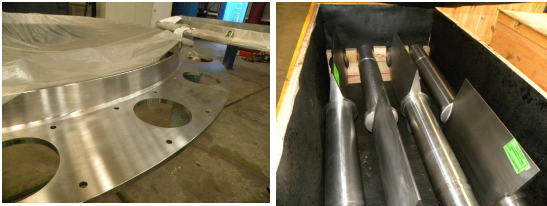
Figuras 4.15. y 4.16. Inspección final anillos fijos y alabes distribuidor.
