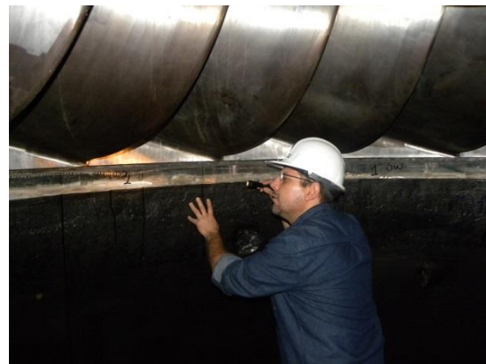
Figuras 5.39. y 5.40. Pruebas de run-out.
