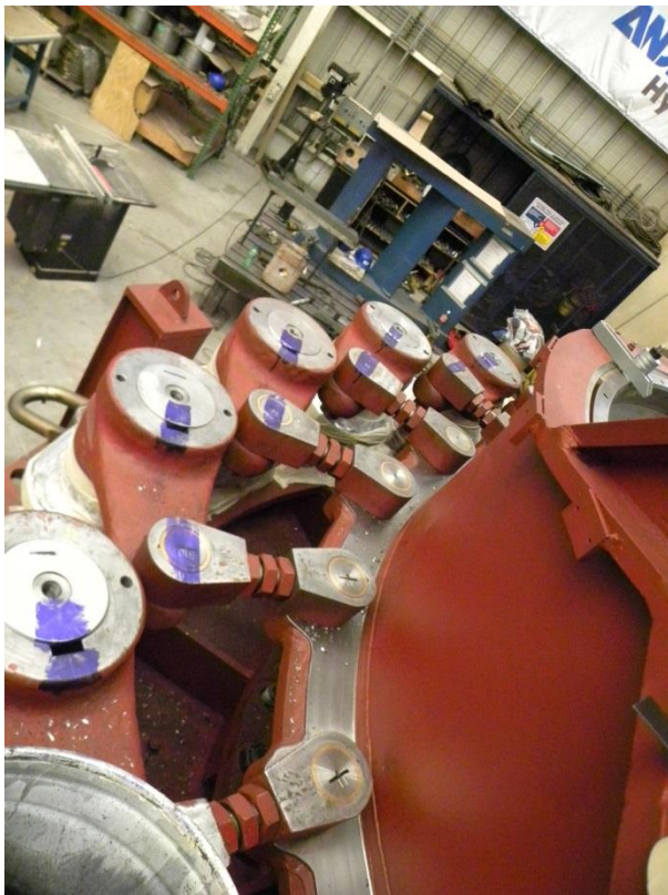
Figuras 5.10. y 5.11. Trabajos de ajuste de cierre hermético de distribuidor.
