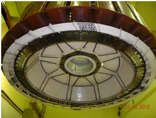
Figuras 5.43. y 5.44. Montaje rotor de generador.
