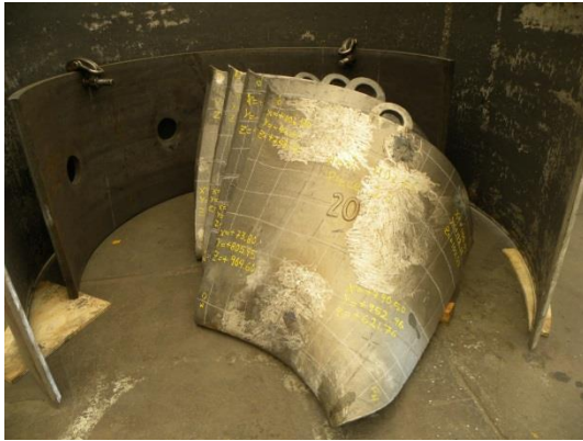
Figuras 4.1 y 4.2. Recepción de álabes y proceso de fresado.
