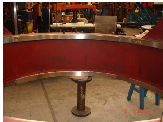
Figuras 5.4. y 5.5. Verificación y ajuste anillo de regulación y sus cojinetes.
