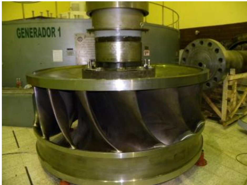
Figuras 4.22. y 4.23. Comparativa de rodete antiguo respecto al nuevo, nótese la gran diferencia respecto al perfil de los álabes.
