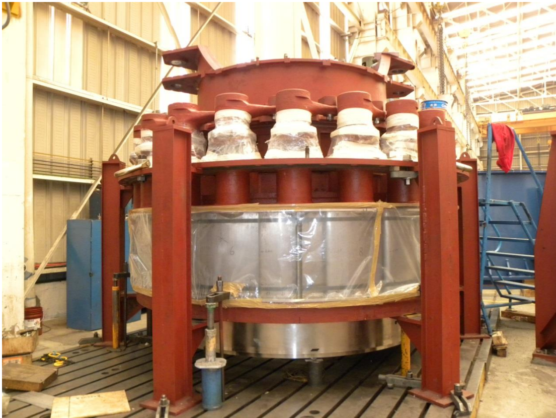
Figura 5.12. Conjunto de turbina con ajustes finales y lista para su envío a planta.
