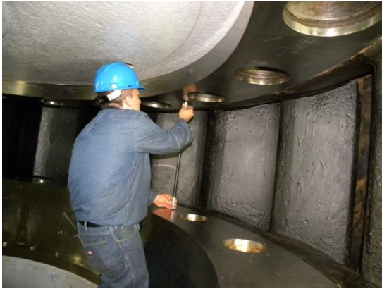
Figuras 5.17. y 5.18. Verificación alineación y paralelismo de escudos.
