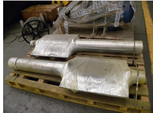
Figuras 4.3. y 4.4. Recepción de anillos fijos y álabes directrices.
