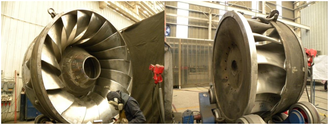
Figuras 4.9. y 4.10. Proceso de pulido de rodete.
