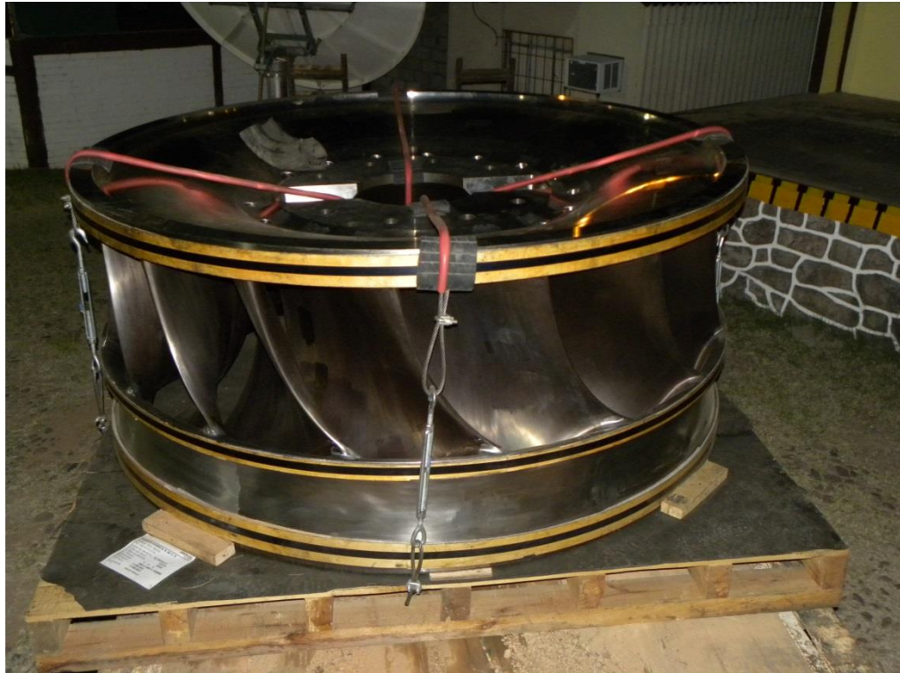
Figura 4.19. Rodete de nuevo diseño de perfil hidráulico
