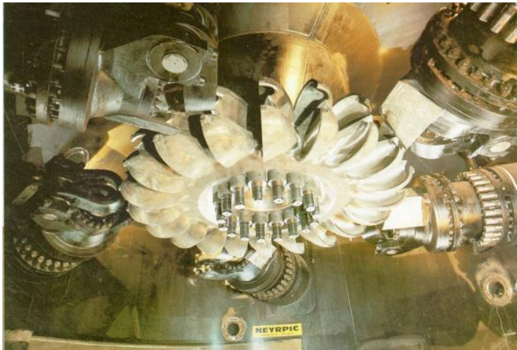
Figura 1.4. Turbina Pelton con 5 toberas (Cortesía Neyrpic Turbines).
