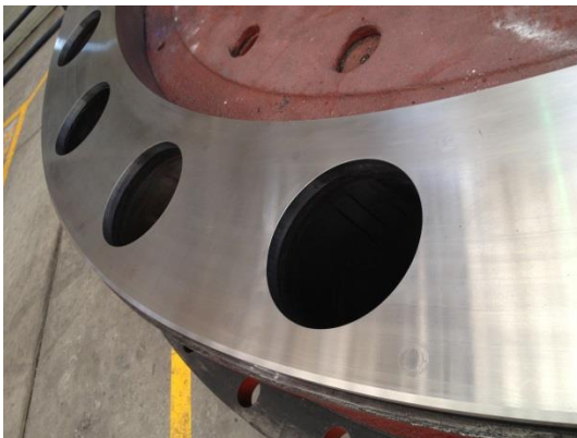
Figuras 5.6. y 5.7. Verificación y ajuste de anillos fijos de turbina.
