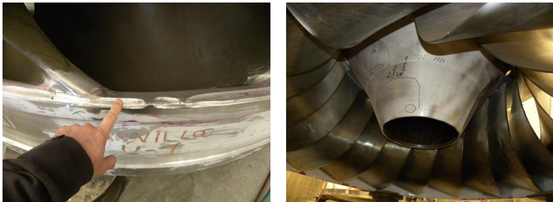
Figuras 4.11. y 4.12. Inspección de rodete después del pulido.
