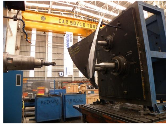
Figuras 4.1 y 4.2. Recepción de álabes y proceso de fresado.
