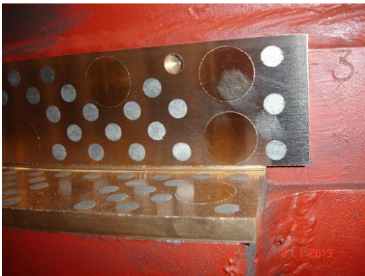
Figuras 5.4. y 5.5. Verificación y ajuste anillo de regulación y sus cojinetes.
