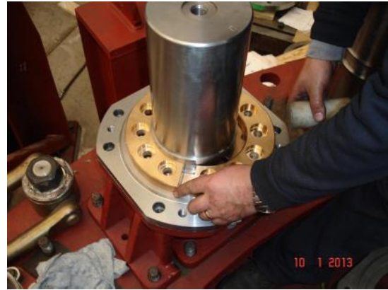
Figuras 5.2. y 5.3. Preparación de cojinetes de álabes.
