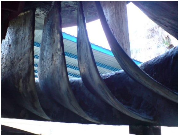
Figura 4.19. Rodete de nuevo diseño de perfil hidráulico
