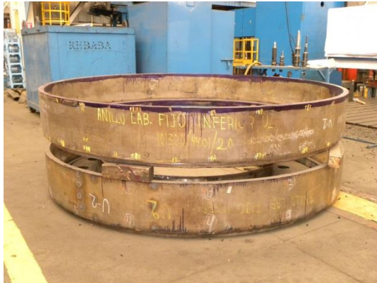
Figuras 4.3. y 4.4. Recepción de anillos fijos y álabes directrices.
