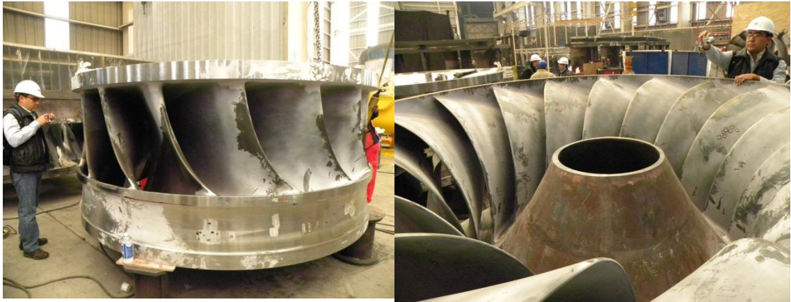
Figuras 4.13. y 4.14. Inspección posterior al tratamiento térmico.
