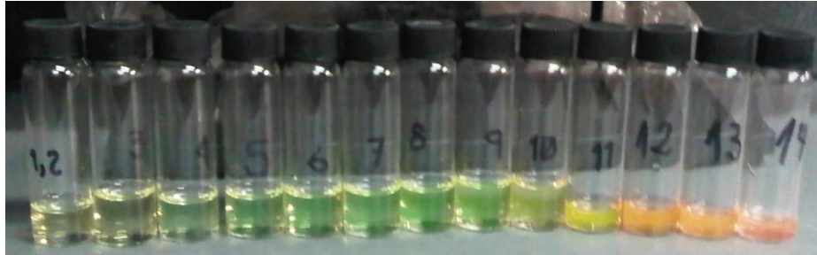
Fig. 8: Fotografía de nanopartículas de CdTe de distintos tamaños expuestas a luz natural
