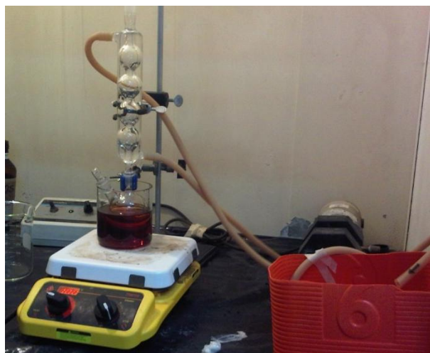
Fig. 7: Fotografía del arreglo experimental para la síntesis de nanopartículas de CdTe
