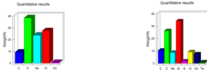
Fig. 26: (Izq.) EDX de nanopartículas de CdTe recién preparada (Der.) EDX de CdTe tras eliminar las sales residuales producidas durante la síntesis
