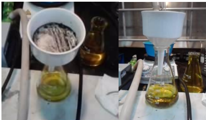
Figura 3.4 Lavados con \text{NH}_4\text{OH} para eliminar iones cloruro y con EDTA para eliminar iones férricos
