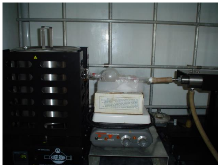
Figura 3.1 Destilación del producto en el micro destilador
