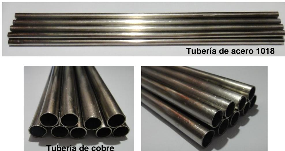
Figura 4.2 Tubería de cobre y acero 1018 con recubrimiento *Ni-P*.
