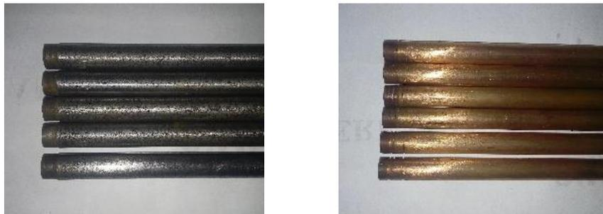
Figura 3.17 Tubo de cobre (*Cu*) y acero 1018 preparados para recubrir.
