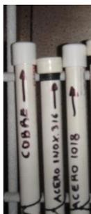
Figura 3.9 Colocación de tubería para oxidación en tubos de PVC.
