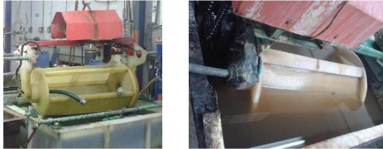
Figura 3.16 Proceso de inmersión del níquel electroless.
