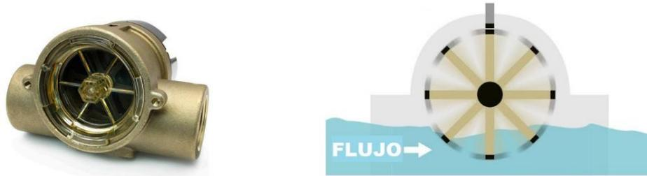
Figura 3.22 Flujómetro de turbina con su esquema de funcionamiento.
