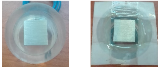
Figura 3.4: Preparación de la probeta para la evaluación electroquímica de las formulaciones. El espesor de la película fue controlado con el apoyo de un vernier digital.
