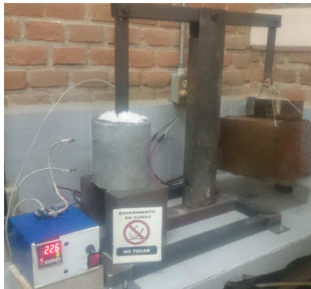
Figura 3.18 Ensayo de termofluencia.
