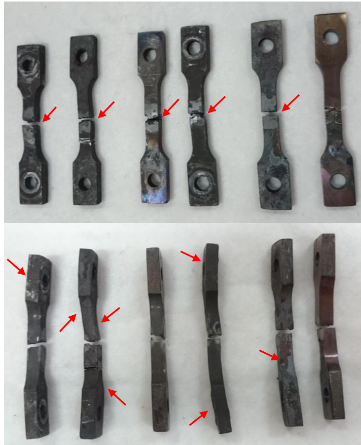
Figura 4.22 Fotografías de las probetas fracturadas por termofluencia.
