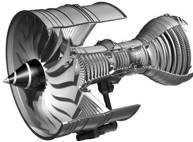
Figura 2.3 Corte transversal de una turbina de motor de aviación.
