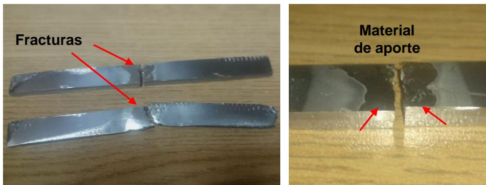
Figura 4.20 Fotografías de las probetas posterior a la prueba de tensión.
