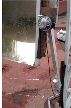
*Figura 11. Actuador lineal instalado físicamente en sitio.*
