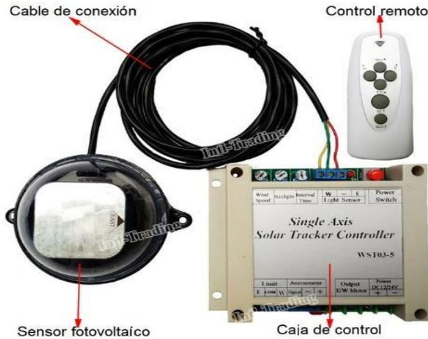
Figura 12. Controlador del Sistema de seguimiento solar (EBay, 2018b).
