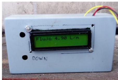
Figura 15. Medidor digital de flujo.
