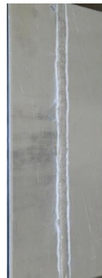
Figura 14. Placa de aluminio 7075-T6 soldada con TIG.
