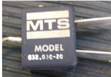
Figura 24. Extensómetro tipo clip, MTS.
