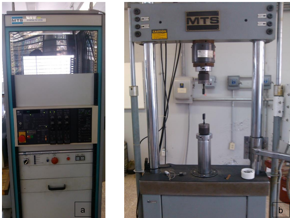
Figura 23. a) Panel de control y b) Máquina servo hidráulica – MTS.
