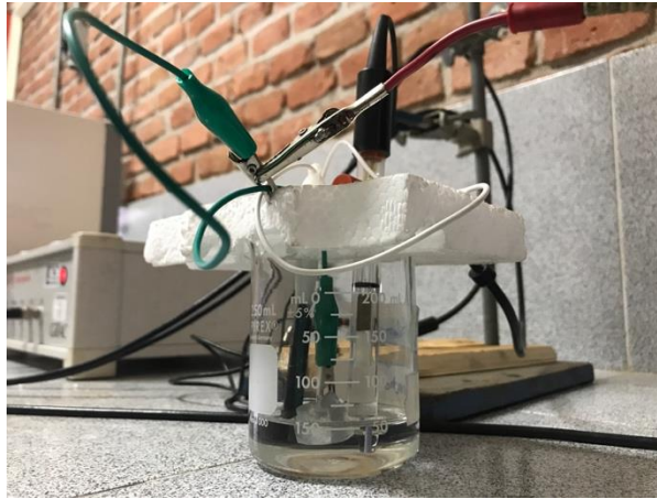
Figura 26. Electrodo sumergido en medio salino (NaCl).
