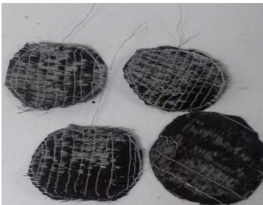
**Figura 3.3** Cátodos fabricados de fibra de carbón unidireccional (fibreGlast 2583-C).
