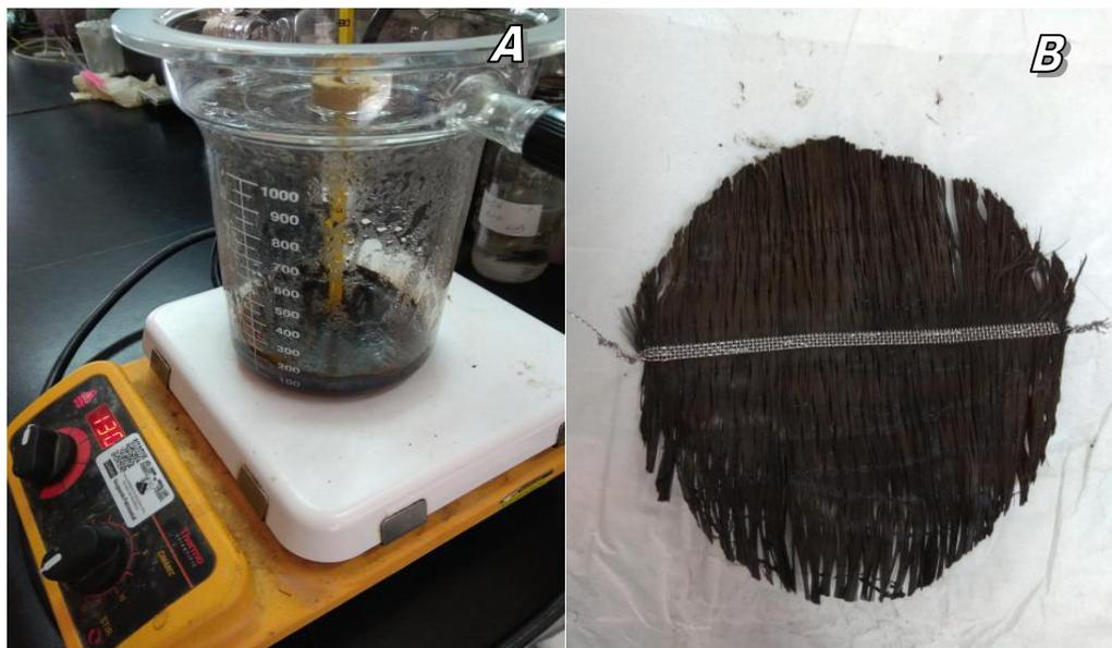
**Figura 3.10** Preparación del cátodo catalizado (A) y cátodo catalizado utilizado en la BCSC (B).
