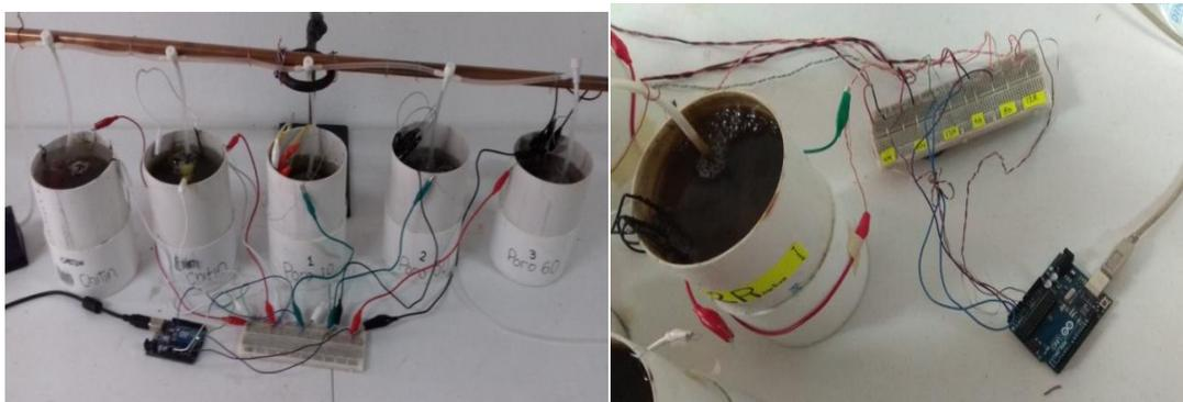
**Figura 3.13** Instrumentación realizada para el estudio de polarización.
