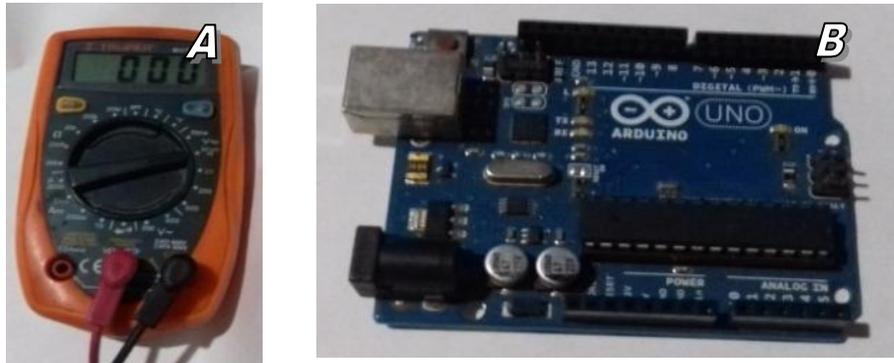
**Figura 3.11** Multímetro digital Trupper (A) y tarjeta Arduino Uno (B) utilizados en la adquisición de datos.
