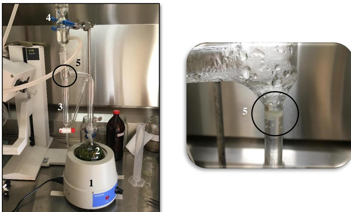
**Figura 13.** Equipo de hidrodestilación, 1: Mantilla de calentamiento, 2: Matraz bola, 3: Trampa clewenger, 4: Refrigerante, 5: Aceites esenciales colectados en la trampa clewenger.
