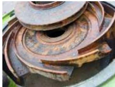
**Figura 3.** Corrosión y pérdida de material en la bomba de enfriamiento de agua.
