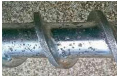
**Figura 11.** Pieza que presenta corrosión por picadura.
