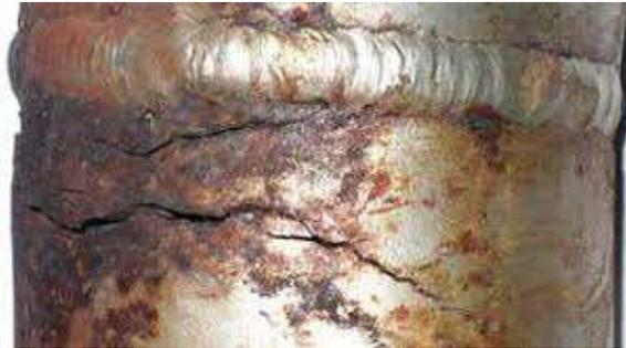
**Figura 5.** Codo con circulación de vapores de agua, hidróxido de sodio y agente polimerizante.
