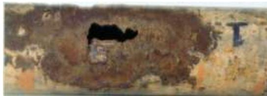
**Figura 6.** Tubería dañada por efecto de la electrolisis.
