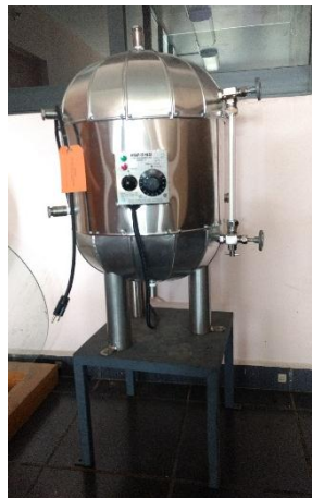
Figura 5.5 Generador de acero inoxidable con resistencia eléctrica variable.
