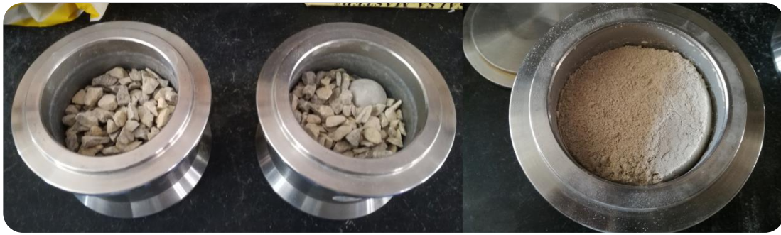
Figura 3.6. Grava antes y después del proceso de molinado.
