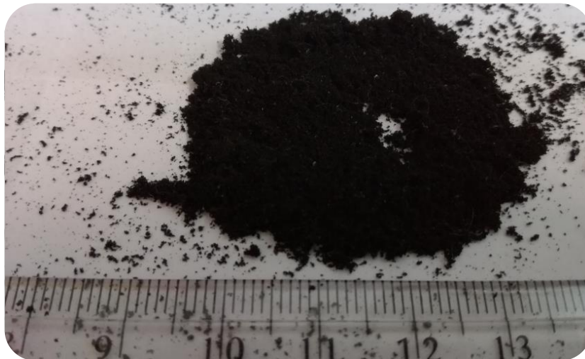
Figura 3.3. Caucho en polvo obtenido por desbaste de la banda de rodamiento y cribado.
