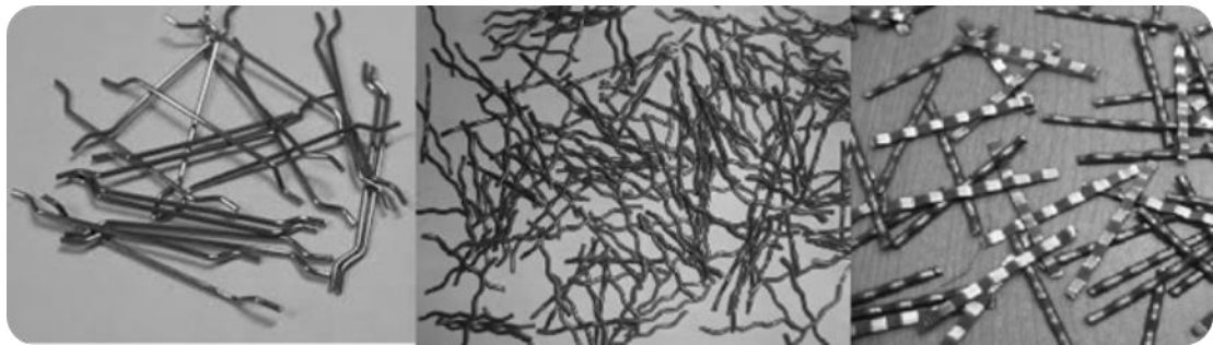
Figura 2.11. Fibras de acero utilizadas en el concreto.
