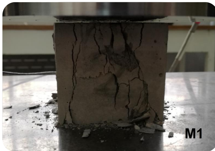
Figura 4.6. Muestra M1 de concreto con caucho en polvo después de la prueba de compresión.
