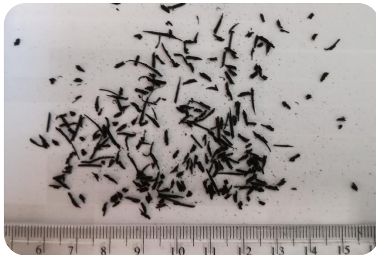
Figura 3.4. Caucho en fibras las cuales han sido pasadas por una criba del número 16.
