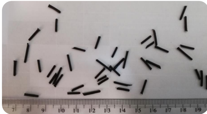
Figura 3.5. Caucho en fibras cilíndricas, poseen un tamaño de entre 8 mm y 11 mm y 1 a 1.5 mm de diámetro en promedio.
