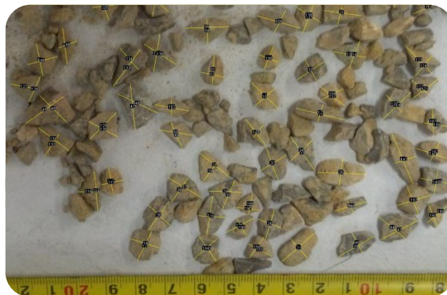
Figura 3.2. Gravilla empleada para las mezclas de concreto, con tamaño promedio de un centímetro de diámetro.
