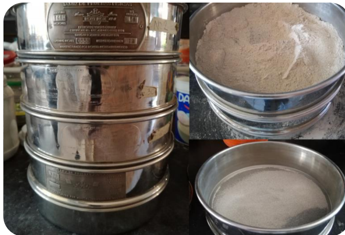
Figura 2.7. Proceso de cribado de las partículas de los agregados.
