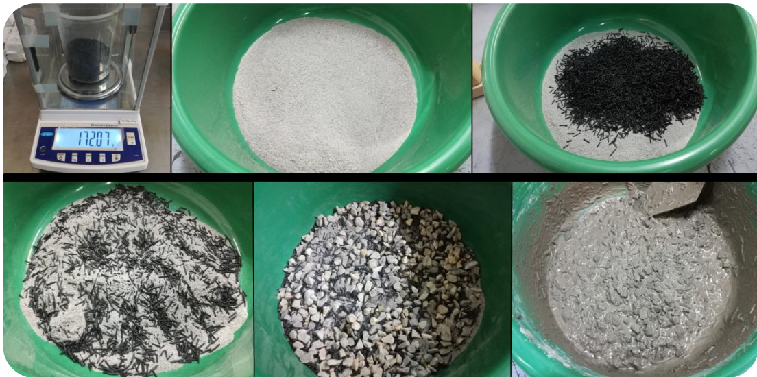
Figura 3.8. Proceso de fabricación de las mezclas de concreto y caucho.
