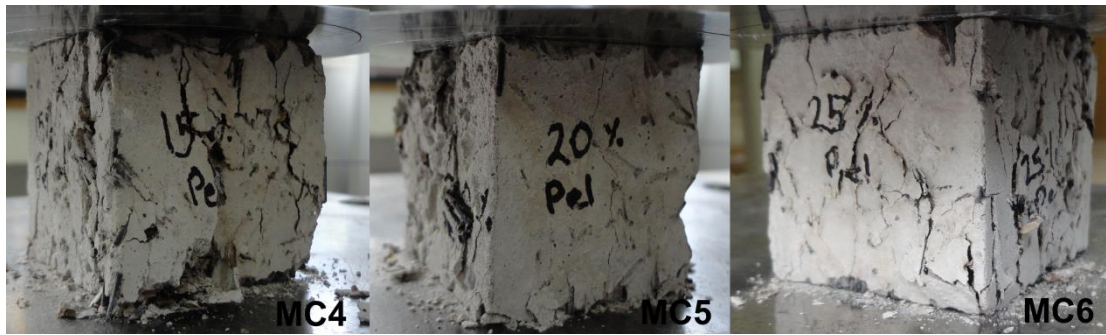
Figura 4.14. Muestras MC4, MC5 y MC6 de concreto con caucho en fibras cilíndricas después de la prueba de compresión.
