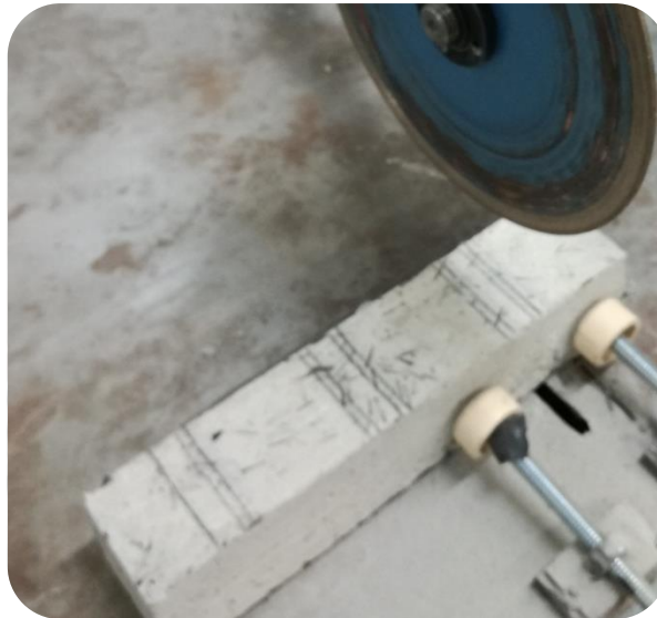
Figura 3.10. Seccionado del bloque de concreto.
