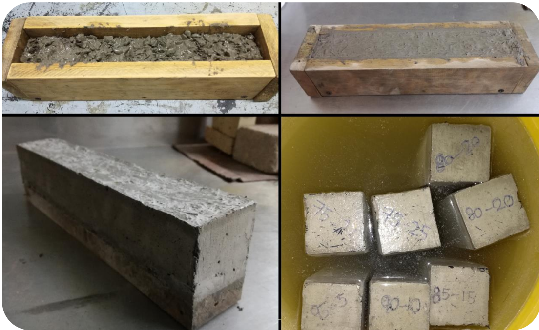
Figura 3.9. Elaboración de probetas de concreto para la prueba de compresión.
