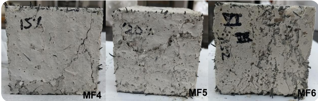
Figura 4.11. Muestras MF4, MF5 y MF6 de concreto con caucho en fibras después de la prueba de compresión.
