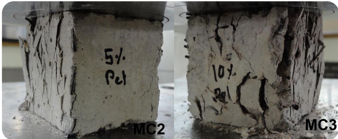
Figura 4.13. MuestrasMC2 y MC3 de concreto con caucho en fibras cilíndricas después de la prueba de compresión.
