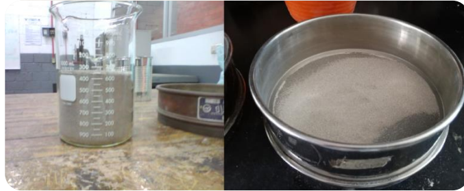
Figura 3.1. Arena utilizada para la fabricación de las mezclas de concreto, tamizada en una criba del número 18.
