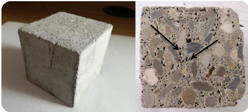
Figura 3.11. Cubo de concreto empleado para la prueba de compresión y vista transversal.
