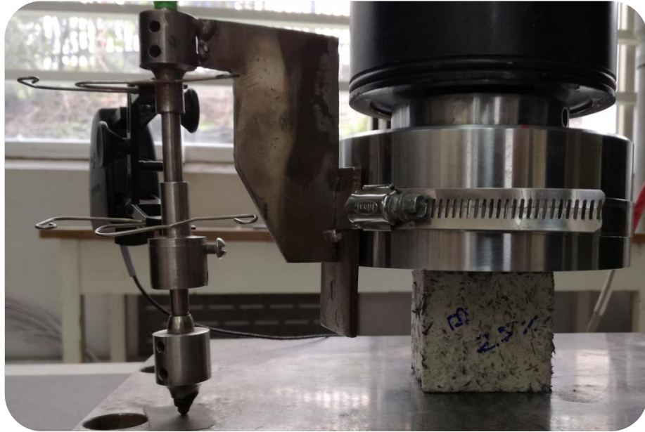
Figura 3.14. Prueba de compresión, el cabezal comprime el cubo y el extensómetro registra el desplazamiento de éste.
