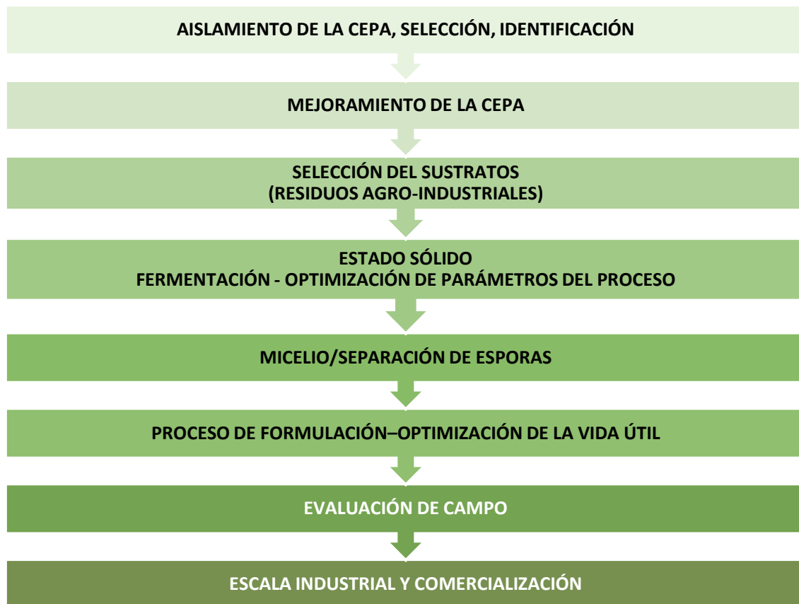
Figura 1. Proceso de producción de Trichoderma spp. mediante sistema de fermentación en estado sólido.
