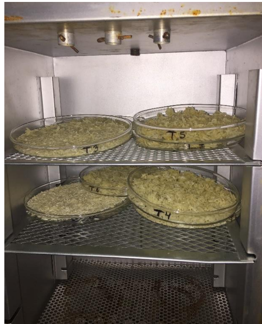
Figura 3. Sustrato de arroz en estufa a 110 °C
