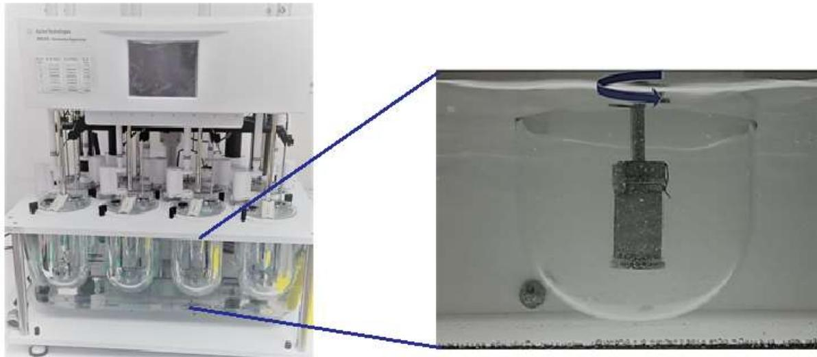
**Figura 14.** Aparato I (canastillas) USP utilizado para las pruebas de disolución de las formulaciones realizadas en condiciones no saturadas (*sink*).
