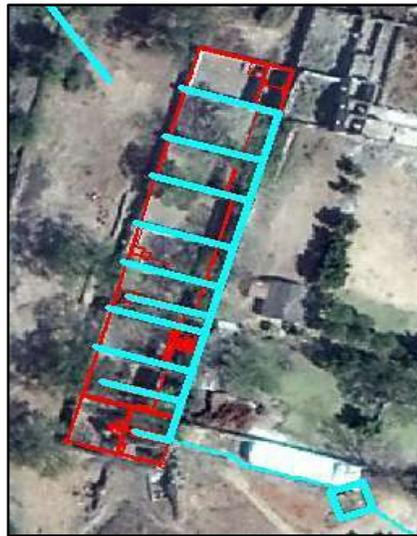
Figura 64. Azul, conducción de agua desde la cisterna. Rojo, construcción de patio de beneficio. Elaboración propia 2016.
