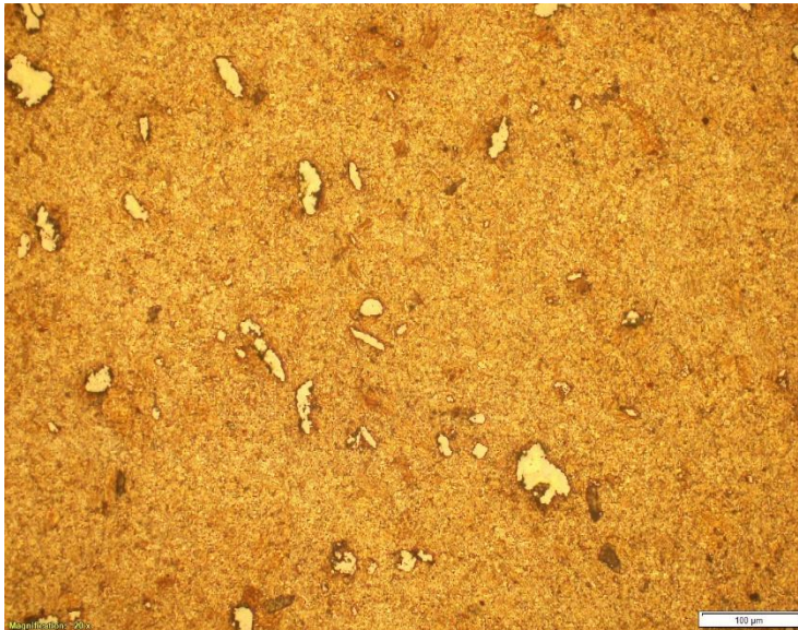
Fig. 58 Imagen hecha por microscopio óptico de aluminio con 5% de intermetálico.
