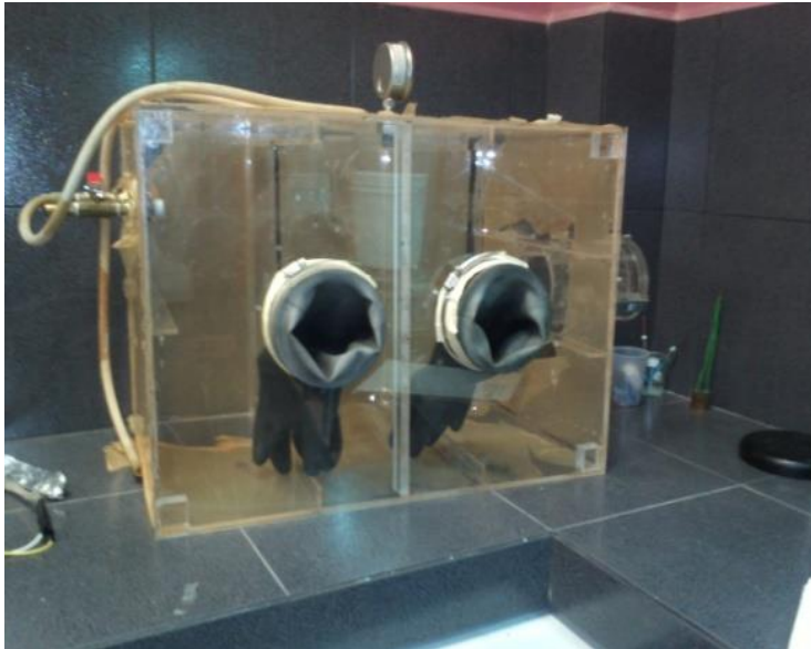
Fig. 6 Cámara de vacío utilizada para la extracción de polvos.
