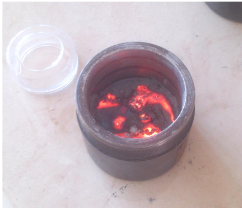
Fig. 32 Oxidación de polvo después de la molienda.
