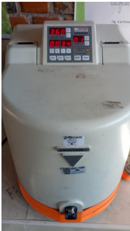
Fig. 34 Molino de baja energía FRITSCH modelo Pulverisette 7.
