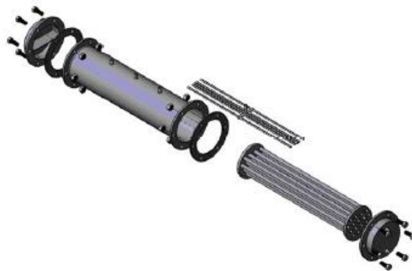
Fig. 3.11 Vista ortogonal completa del absorbedor (Huicochea, 2009)
