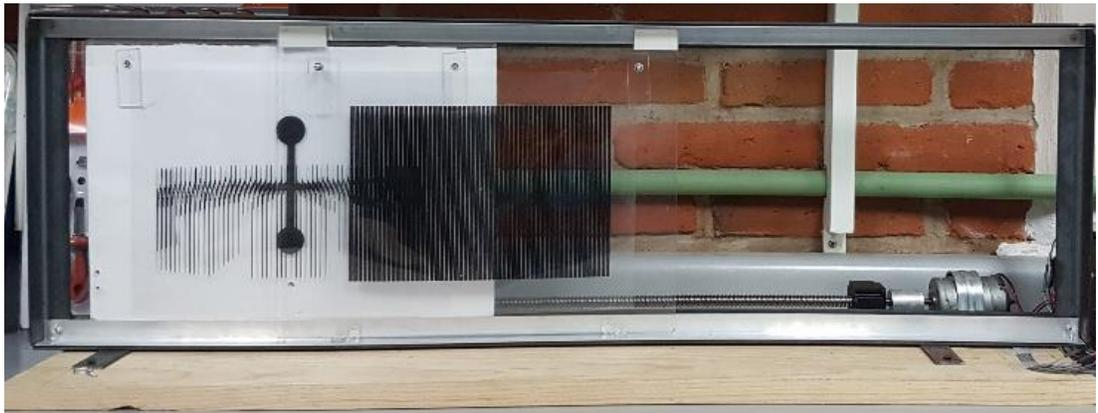
Figura 3.14 Prototipo de patrones de interferencia de Moiré.
