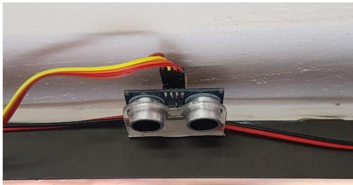
Figura 3.33 Sensor HC-SR04 instalado en el marco de la puerta.
