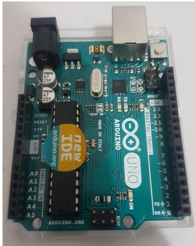
Figura 3.30 Placa Arduino uno.
