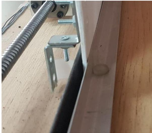
Figura 3.16 Guía inferior de la lámina de acrílico.
