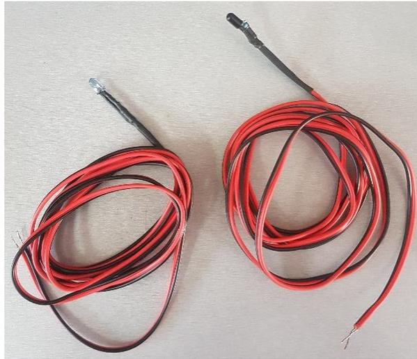
Figura 3.26 Diodos infrarrojos soldados.
