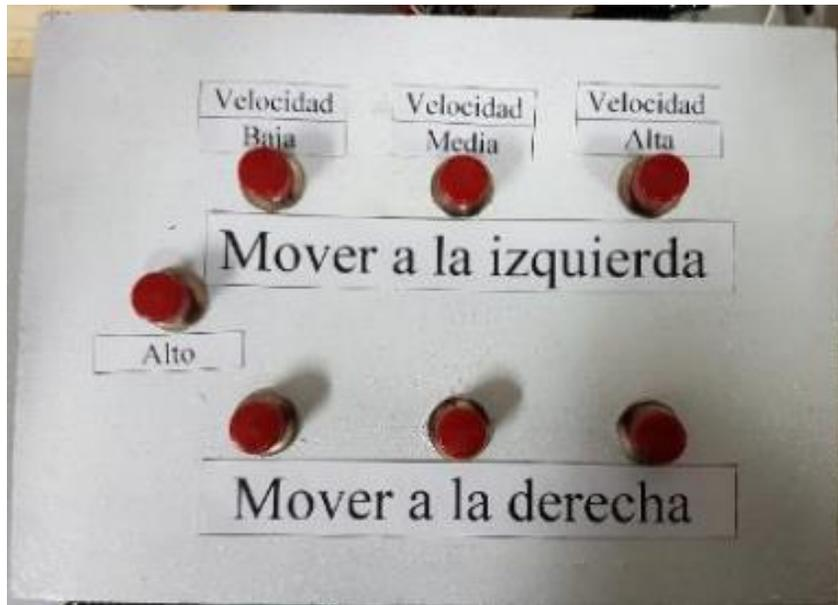
Figura 3.22 Caja de control con sus botones de trabajo.
