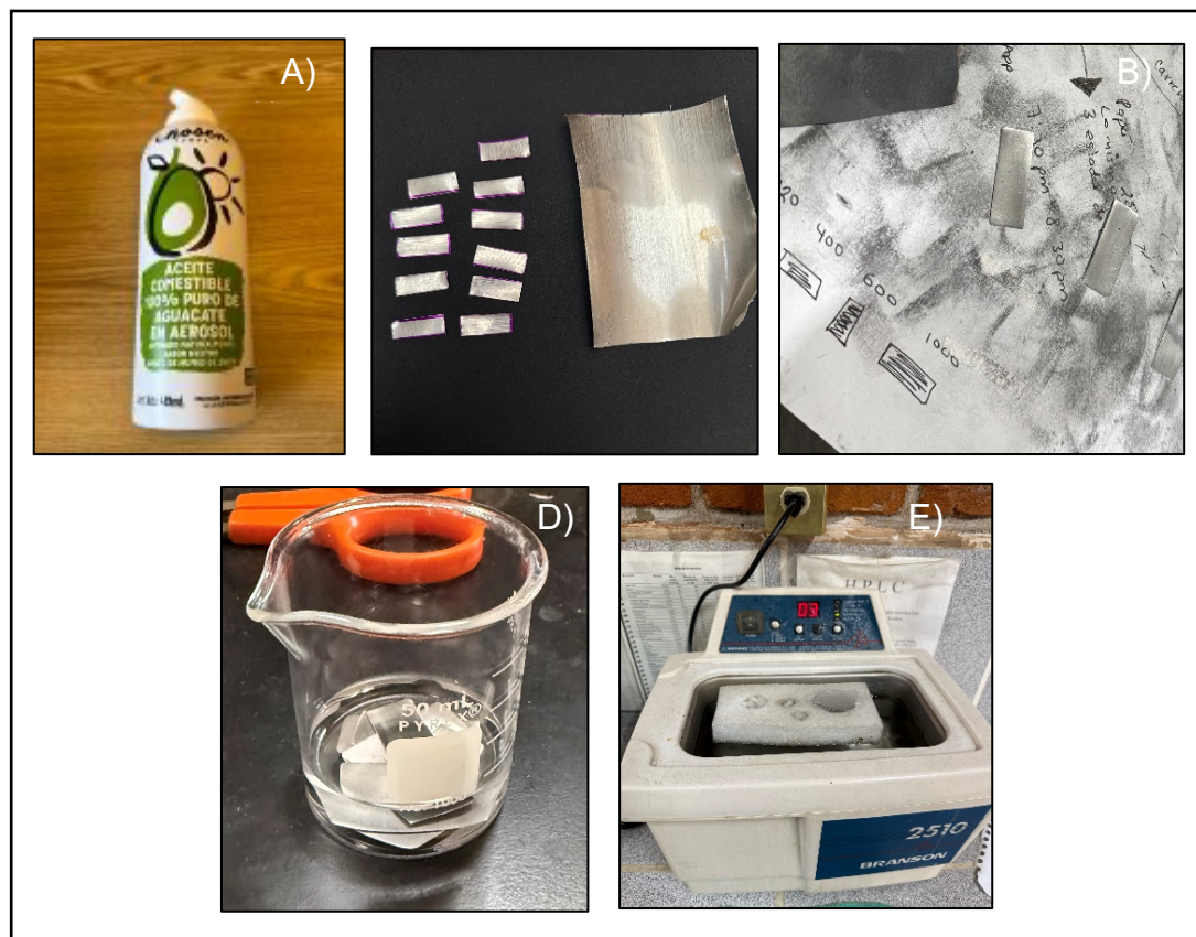
Figura 11. A) lata de aceite, B) aluminio cortado C) electrodos lijados D) electrodos en acetona y E) baño ultrasónico.
