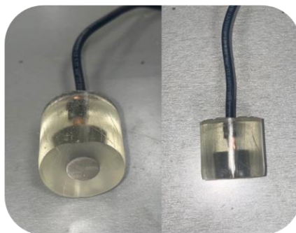
Figura 17. Probeta de acero al carbono AISI 1018, encapsulada con resina epóxica con alambre de cobre, pulida y lavada con acetona para su posterior uso.
