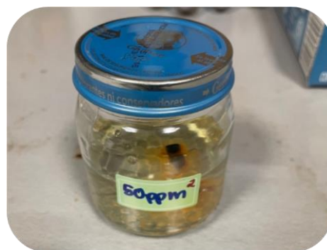
Figura 14. Solución 0.1 M \text{Na}_2\text{SO}_4 + 3 wt% NaCl en agua destilada a 50 ppm de Cefalexina caduca con la muestra inmersa en el día 7 donde se observan productos de corrosión formados.
