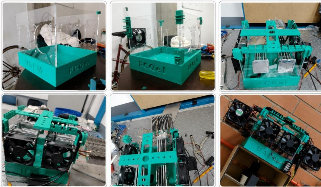
Figura 3.13. Ensamblaje general del prototipo de captación de agua atmosférica [fuente: elaboración propia].
