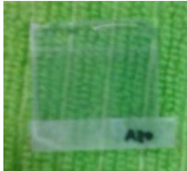
Fig. (4.26) Depósito de TiO 2 -np solución a baja concentración sobre FTO/TiO 2 -cp, un ciclo, horneado a 450 °C por una hora.
