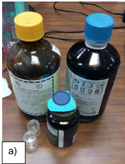
Figura 19. a) Reactivos: ácido nítrico, ácido clorhídrico y glicerina b) Preparación de reactivo gliceregia.
