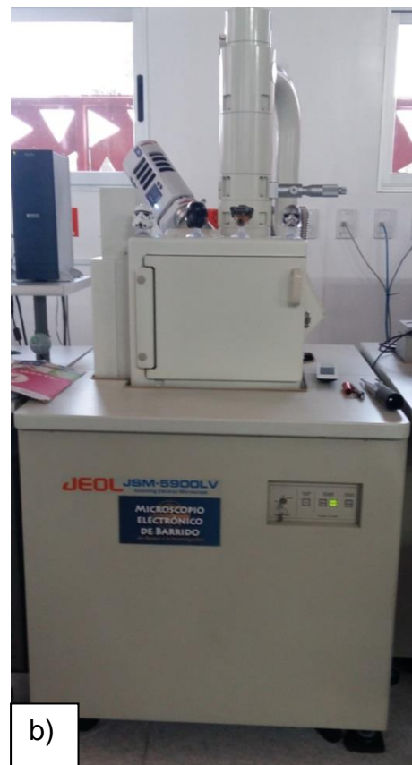
Figura 13. a) SEM en operación de mapeos b) SEM utilizado, ubicado en la USAII, UNAM.
