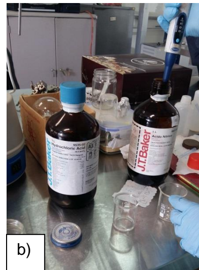
Figura 19. a) Reactivos: ácido nítrico, ácido clorhídrico y glicerina b) Preparación de reactivo gliceregia.
