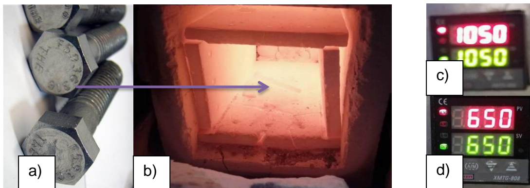
Figura 17. a) Tornillos de acero 316 nuevos b) Interior de mufla con material dentro para tratamiento c) Temperatura de solubilizado d) Temperatura de envejecido.
