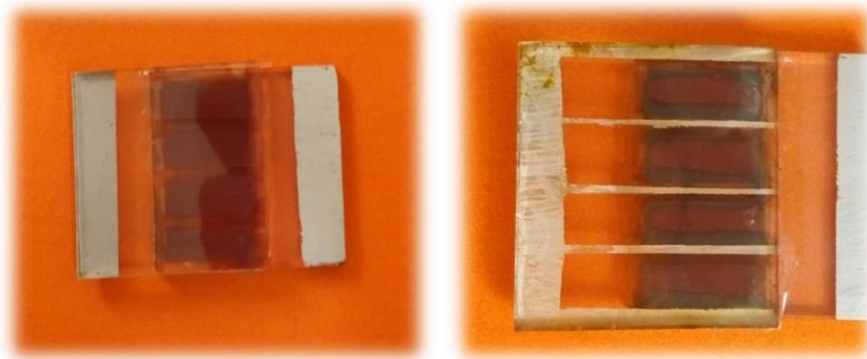
Figura 5. 7 Fotografías de módulos solares DSSC de área activa de 2 cm 2 con y sin pistas de plata
