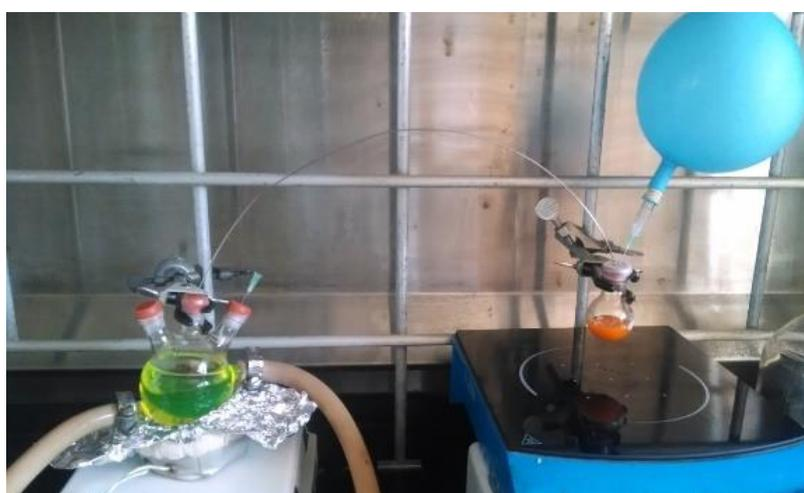
Figura 2. 27 Traslado de monómero y nanopartículas de CdS al matraz de reacción.
