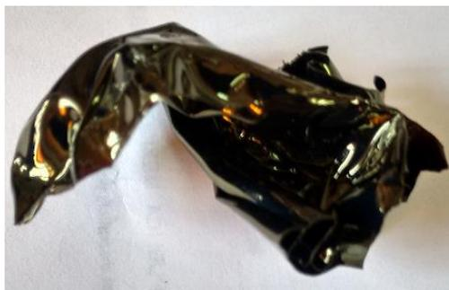
Figura 2. 43 Composito P3HT/NPs de CdS precipitación química funcionalizado con dietil 2-hidroxi-2-(tiofen-3-il)etil] fosfonato COMP-F3MW.
