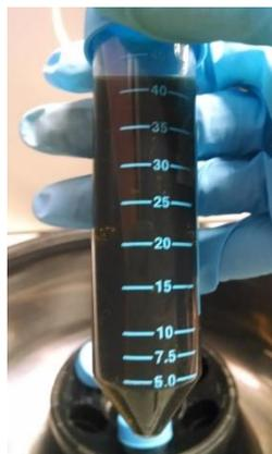
*Figura 2. 22 Polímero lavado mediante aceleración centrifuga.*
