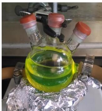
*Figura 2. 21 Reactor de la Síntesis de P3HT.*
