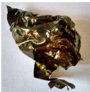
*Figura 2. 31 Composito P3HT/CdS por microondas.*
