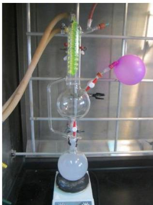
*Figura 2. 4 Destilación de cloroformo.*
