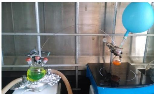
Figura 2. 39 Traslado de monómero y nanopartículas funcionalizadas de CdS al matraz de reacción.
