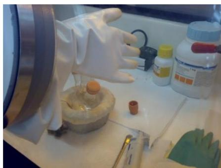
Figura 2. 20 Cámara de guantes ya purgada, con reactivos utilizados.
