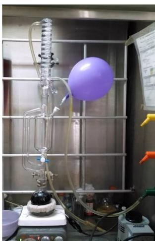
Figura 2. 1 Sistema para secado de THF.
