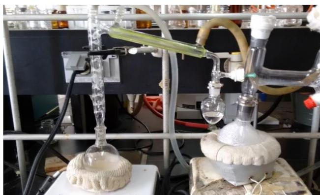
*Figura 2. 3 Sistema para secado de diclorometano.*
