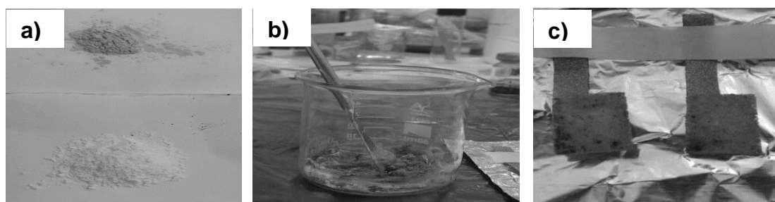
Fig. 3-3 Elaboración de electrodos positivos a) Hidróxido de níquel y PTFE. b) Mezcla de los materiales en un beaker. c) Electrodo seco y compacto en malla de Níquel.
