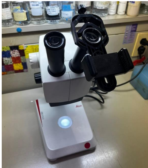
Figura 5: Representación del manejo del adaptador para teléfonos celulares en el ocular del estereoscopio
