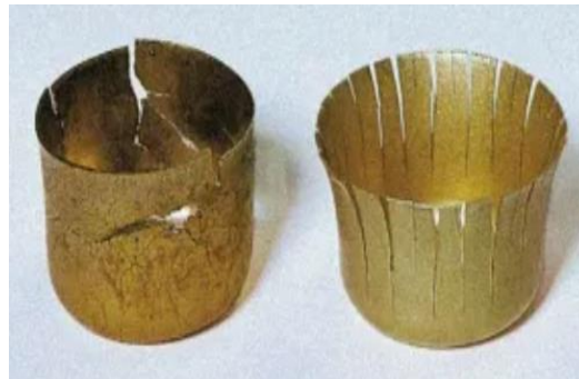
Figura 10. Corrosión por agrietamiento.
