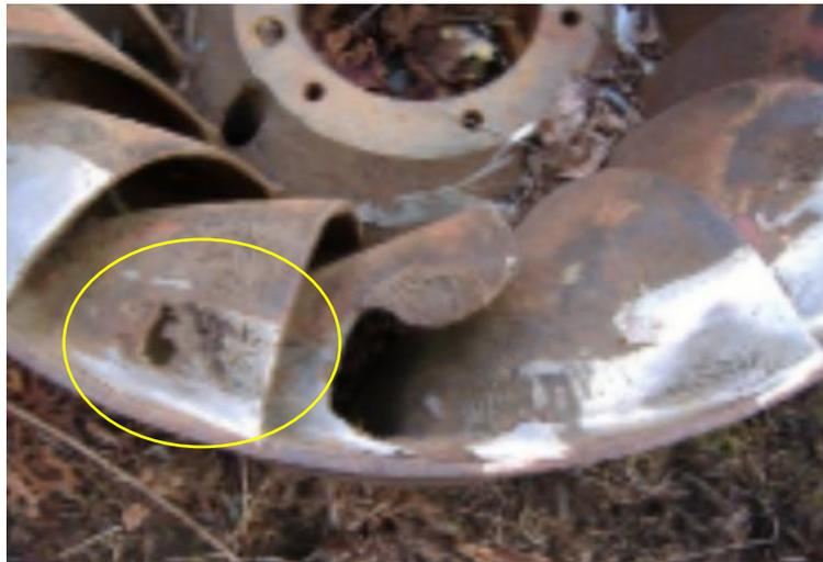
**Fig. 6** Corrosión por cavitación
