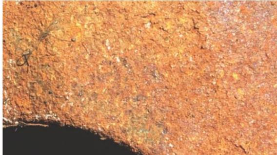
**Fig. 2** Representación de la corrosión uniforme.
