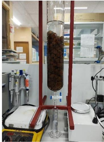
*Figura 13:* Filtro tipo batch empaquetado con tezontle y la muestra
