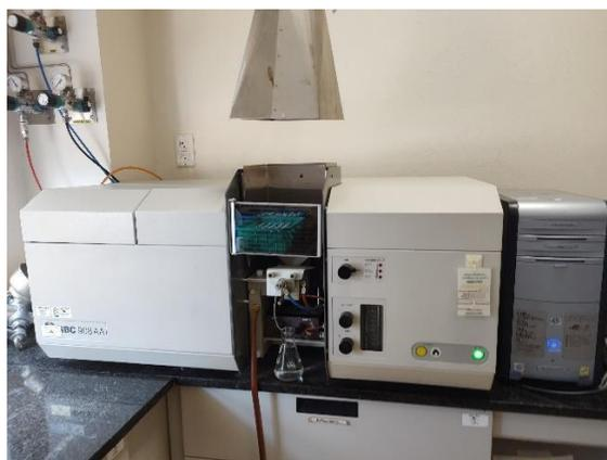
**Figura 16:** Espectrofotómetro de absorción por flama
