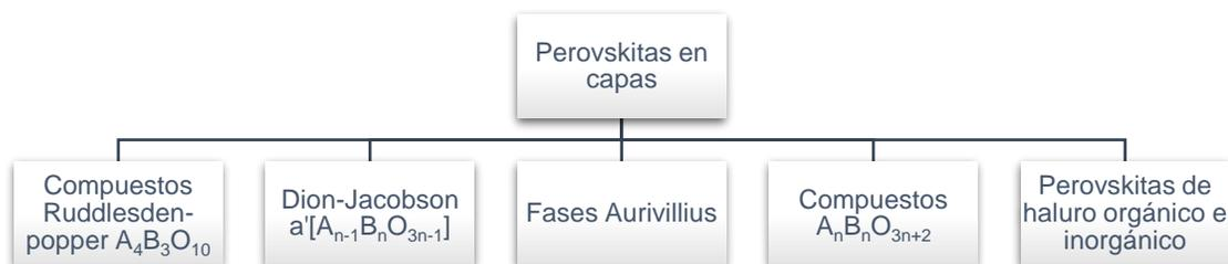
Figura 2.5 Esquema de los diversos tipos de perovskitas en capas.
